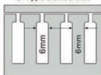
标准型出线孔尺寸 S-Type slotted size
